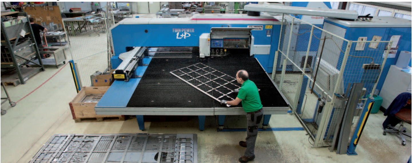
An der Finn Power Laser-Stanzmaschine werden aus grossen Blechplatten die einzelnen Teile gefertigt.
