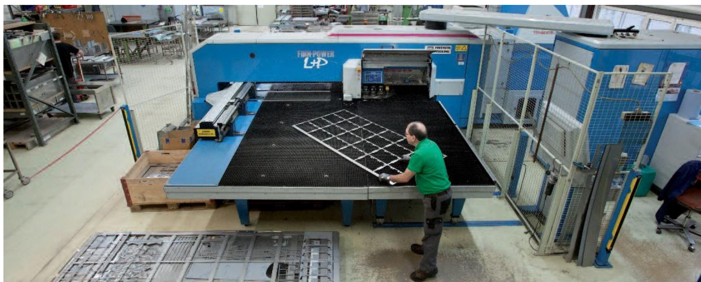
Sur la poinçonneuse laser Finn Power, les différentes pièces sont fabriquées à partir de grandes plaques de tôle.
